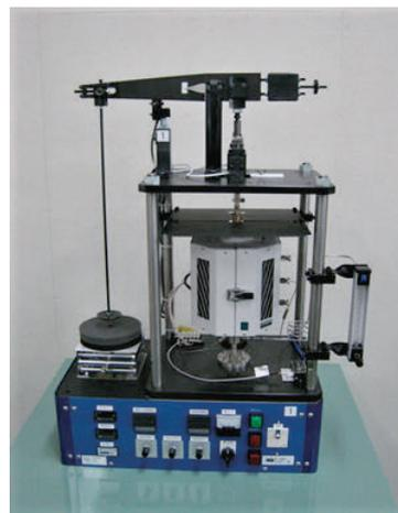
図5 ミニチュアクリープ試験機の外観
