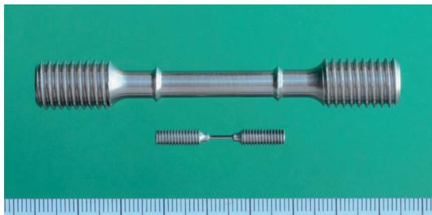
図3 ミニチュアクリープ試験片の外観
