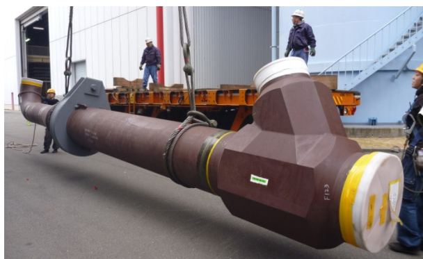
写真2 改良9Cr-1Mo鋼製主蒸気管の一部
