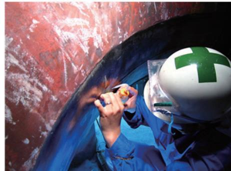
図9 開発試薬を用いたレプリカ採取作業
