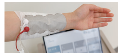
図2 システムは、接触を検知するセンサーシートとタブレットのセットで構成される。使用する際は患者の点滴刺入部に包帯を巻き、その上にシートを貼り付ける。
